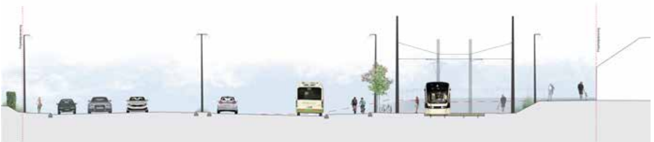
Nedskaleret tværsnit ved Kertemindevej og Station Seden. Tegningsnr: OL2-NR-UBR-DR-00514
