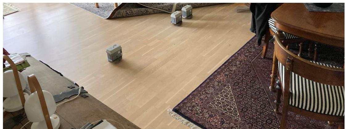
*Figur 2: Måleopstilling i stuen, bestående af vibrationsmålere (MP1 og MP3) på gulvet i midten af rummet nærmest Letbanen og referencemåler (MP2).*
