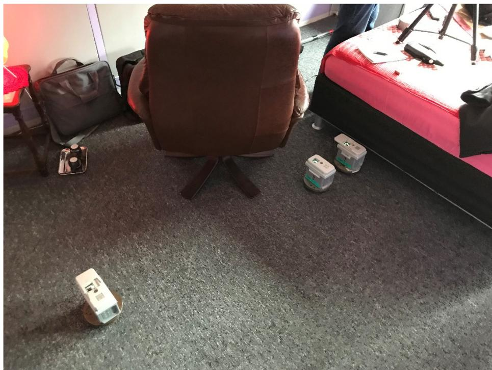
Figur 2: Måleopstilling bestående af vibrationsmålere (MP1 og MP3) på gulvet i midten af rummet nærmest Letbanen og referencemåler (MP2) til venstre på billedet.
