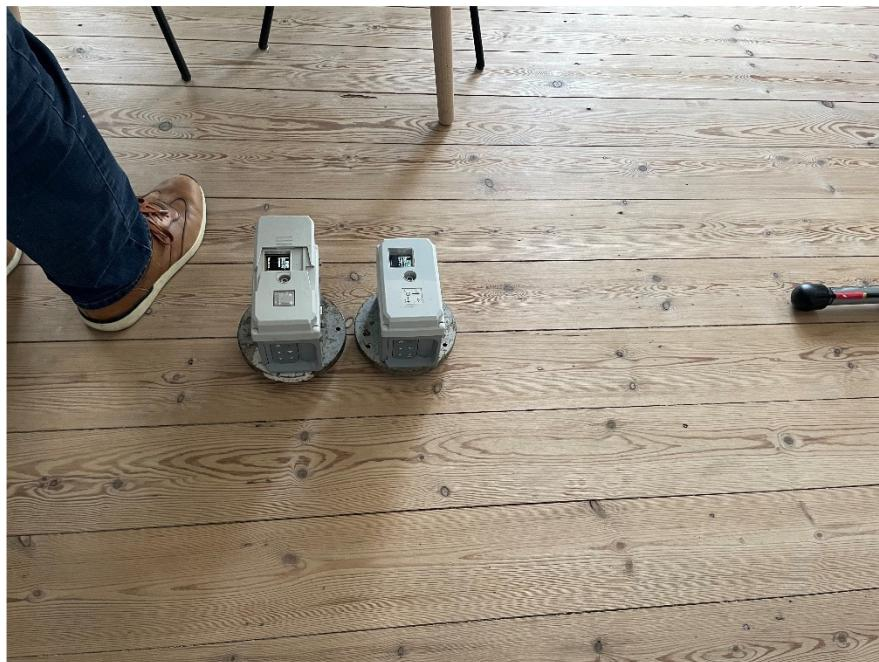
Figur 2: Måleopstilling i stuen, bestående af vibrationsmåler (MP1) på gulvet i midten af rummet nærmest Letbanen og referencemåler (MP2).
