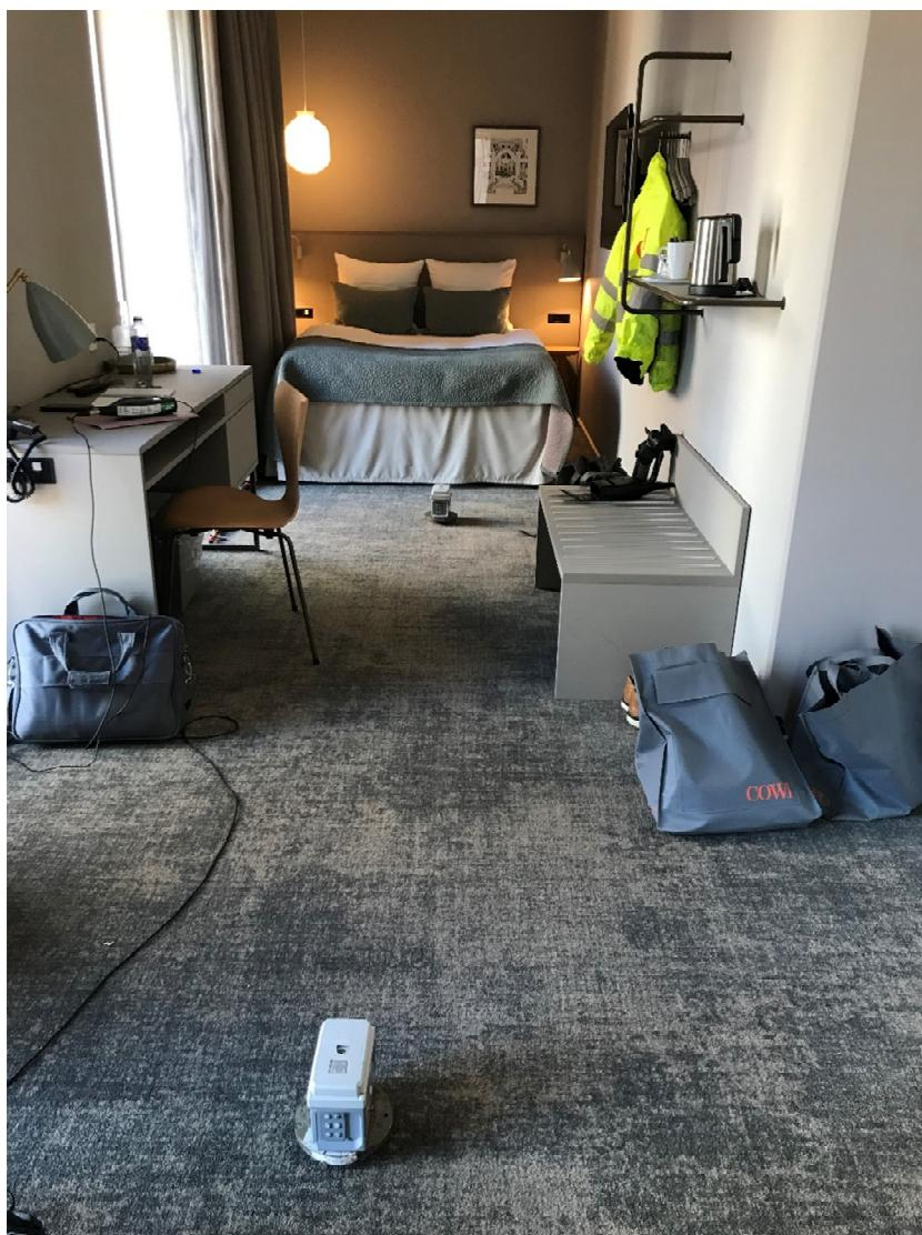
*Figur 3: Vibrationsmåler, bestående af hovedmåler MP1 og referencemåler MP2, midt på gulvet på hotelværelse 132 parallel med Letbanen.*
