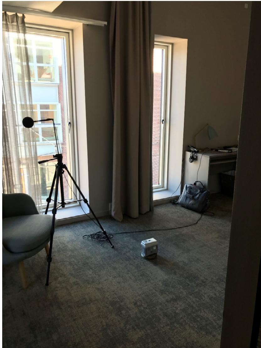
*Figur 2: Måleopstilling på hotelværelse 132, bestående af vibrationsmåler (MP1) på gulvet og lavfrekvent støjmåler.*
